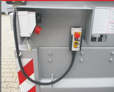
Bedienelemente (abnehmbar) und Elektro-Anschluss in PR rechts
