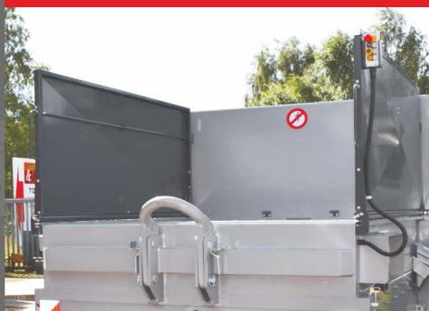
Längsgeteilter Deckel über der Einfüllöffnung - Bedienelemente einhängbar
