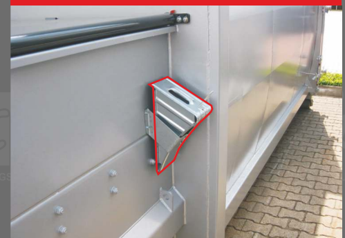
2 Hemmschuhe - während des Transportes in PR links und rechts einhängbar
